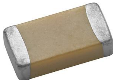
44. Irudia: SMD motako kondentsadore baten itxura
