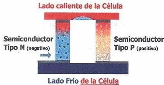
Figura 9: Esquema de funcionamiento de una Celula Peltier
