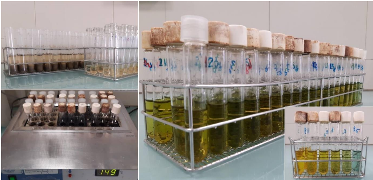
Figura 4.15 | Fotografías del procedimiento analítico para la determinación del C de la biomasa microbiana (CBM), muy similar al procedimiento para medir el C orgánico soluble (COS).
