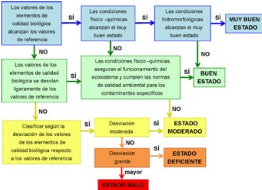
Figura 3. Diagrama de prioridades en el cálculo del buen estado ecológico a partir de la Directiva 2007/60/CE y de la guía REFCOND (adaptado de Wallin et al. , 2003 y Toro et al. , 2009).
