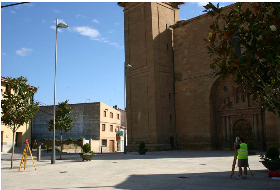
Figura 16. Disposición de las estaciones en campo.
