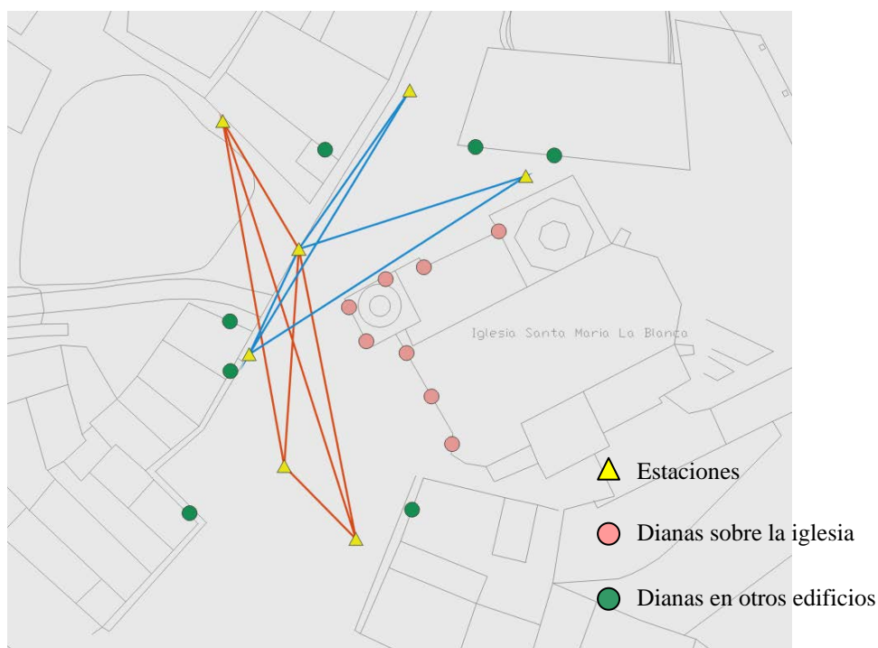
Figura 13. Esquema de la distribución de estaciones.
