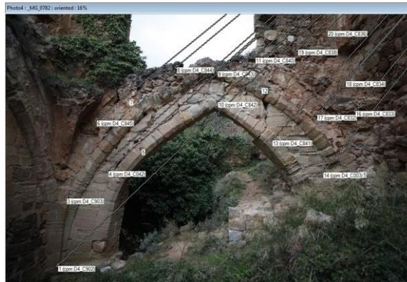
Imagen 5.85: Fotografía con puntos de control antes de procesar
