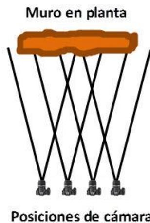
*Imagen 4.4: Esquema de disposición de fotografías estereoscópicas*
