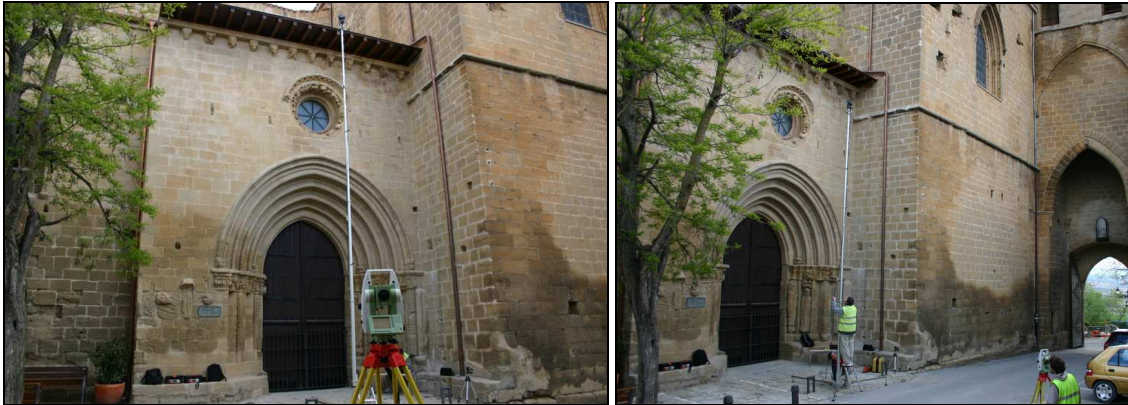
Figura 5.16. Toma de fotografías con el jalón telescópico.
