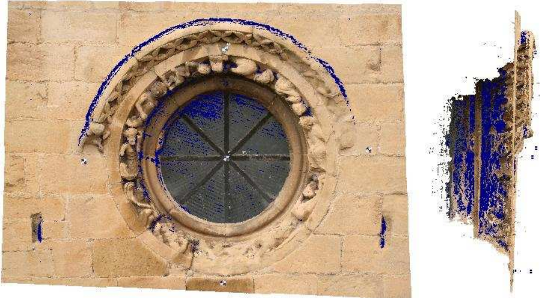
Figura 5.21. Muestra de una nube densa generada por PhotoModeler . En azul, los vacíos dejados por los ocultamientos.
