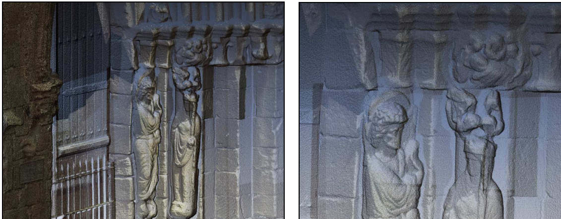
Figura 5.6. Detalle de la nube obtenida con el escáner (LDGP, 2008).
