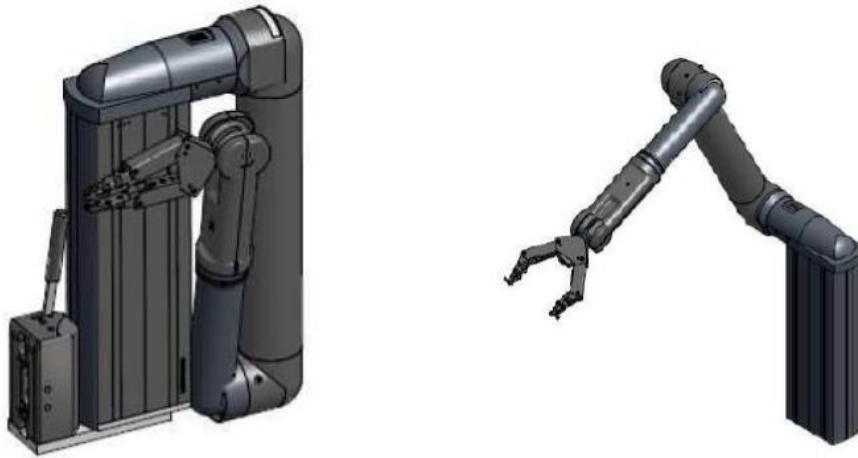
Fig. 8 A la izquierda robot plegado. A la derecha robot desplegado.
