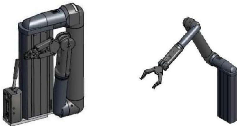
Fig. 15 A la izquierda robot Plegado. A la derecha robot desplegado.
