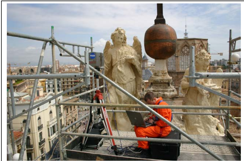
Fig. 4.- Sensor montado en la parte superior de la Portada.
