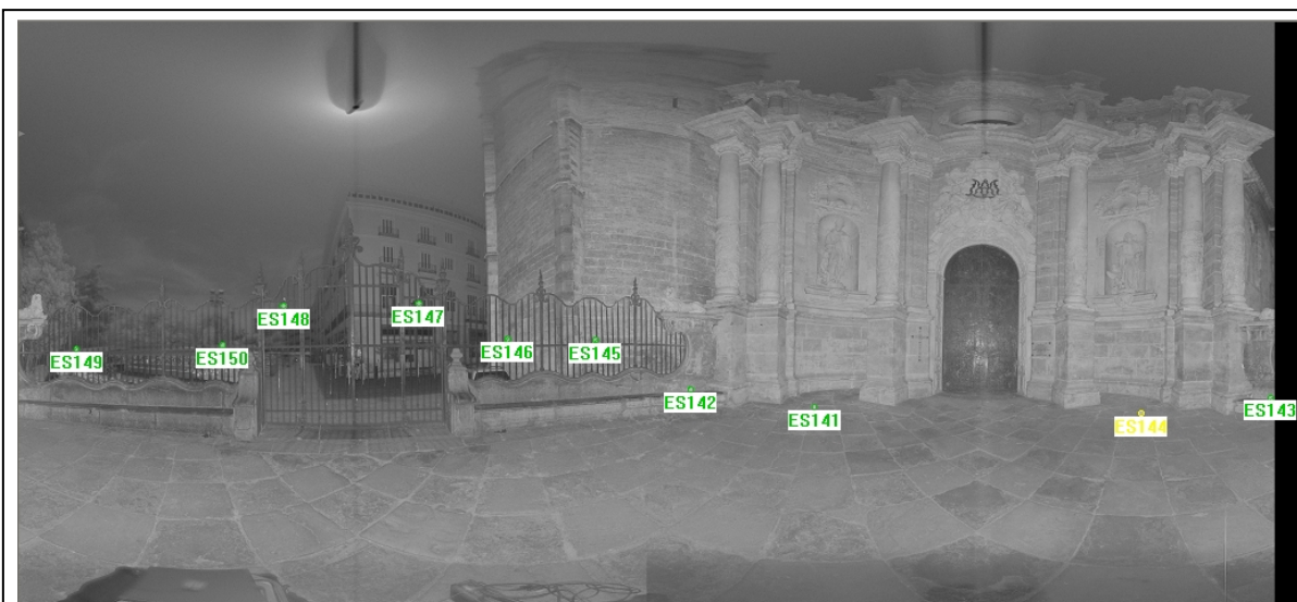
A3.2.- Imagen 2D de reflectividad de la nube de puntos con las esferas identificadas.
