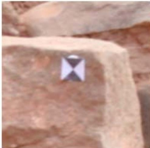
Imagen 4. Diana bicolor para la señalización de un punto de apoyo fotogramétrico.
