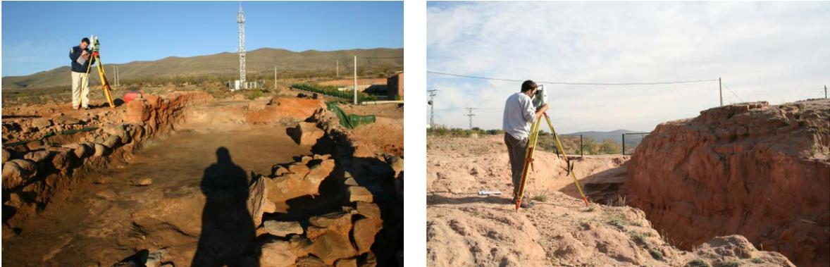
Imágenes 6. Fase del levantamiento volumétrico mediante estación total.
